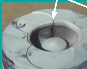
Crack initiation site
